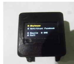
Gambar 10. Perangkat pada Posisi Standby
